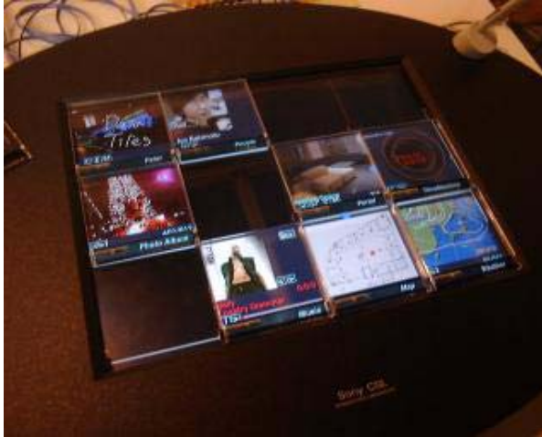
Figure 4. Les DataTiles (Rekimoto et al. , 2001) se présentent sous la forme de tuiles transparentes que l'utilisateur dispose sur une table et sur lesquelles des informations sont rétro-projetées. Chaque tuile est identifiée et joue un rôle particulier (curseur, carte géographique, etc.). L'utilisateur peut les composer, par exemple placer la tuile "météo" sur la tuile "ligne du temps" pour découvrir le temps qu'il fera demain : la topologie des tuiles est un véhicule sémantique.
