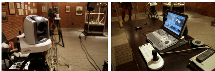
Figure 2. Caméra télécommandée et module de commande (TEMUSE)
